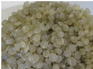
La régénération, également appelée granulation, est un processus de valorisation du plastique qui permet aux régénérateurs de produire des granulés. Longuement traitée, purifiée, homogénéisée, la matière produite est prête à être
